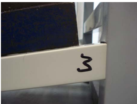
Fig.4. Legbord belast met 225 kg
