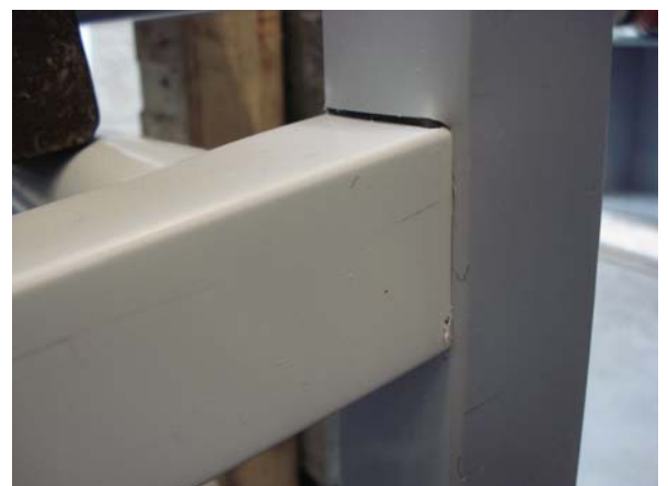
Fig.5. Legbord belast met 225 kg
