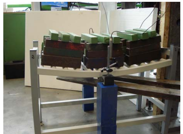
Fig.3. Legbord belast met 225 kg
